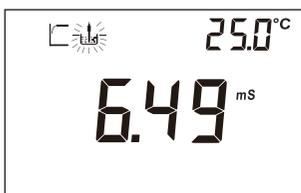
1. 测量模式时，按  $\text{CAL/INFG}$  键进入校准状态，将电极置入标准液中，此时显示测量到的电导度值。
