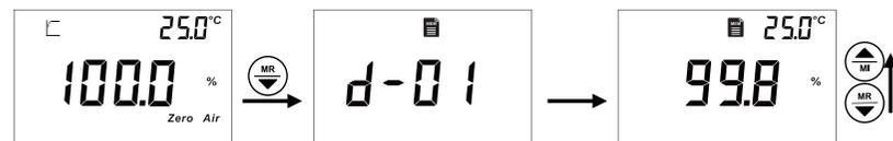
在测量状态用户按 键进入保存数据的浏览，首先显示出所保存数据的批次，然后闪烁显示出这批次的数据，在这状态下用户可以按 键或 键查看保存的所有数据。按 键为退出回到测量状态。如显示“NONE”表示存储器内无数据，仪表自动返回到测量模式。
